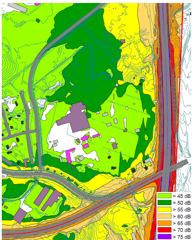
Kuva 15. Yöajan keskiäänitaso ennusteverkolla ja -liikenteellä (Tuusulan Focus katusuunnitelman meluselvitys).
